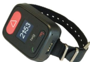
Pratique, ergonomique et simple d'utilisation, le **Twig Embody** propose un **bouton SOS pour déclencher l'alarme**. Ses fonctionnalités PTI permettent de détecter la perte de verticalité, ou l'absence de mouvement.
