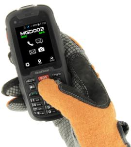
Appareil 2 en 1, il permet d'effectuer une communication classique et est doté de **fonctionnalités d'alerte** pour travailleur isolé. Avec son **application native**, il comporte une **option GPS et NFC** qui permet la localisation immédiate du salarié en danger.
