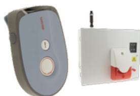
Spécialisé **pour les milieux industriels**, il fonctionne sans réseau GSM, et communique par onde radio (420-475 MHz). **L'alarme du A51 est transférée vers un boîtier flash/sirène** qui alerte le personnel sur site et/ou transmet l'alarme par **message vocal ou SMS à l'extérieur**.
